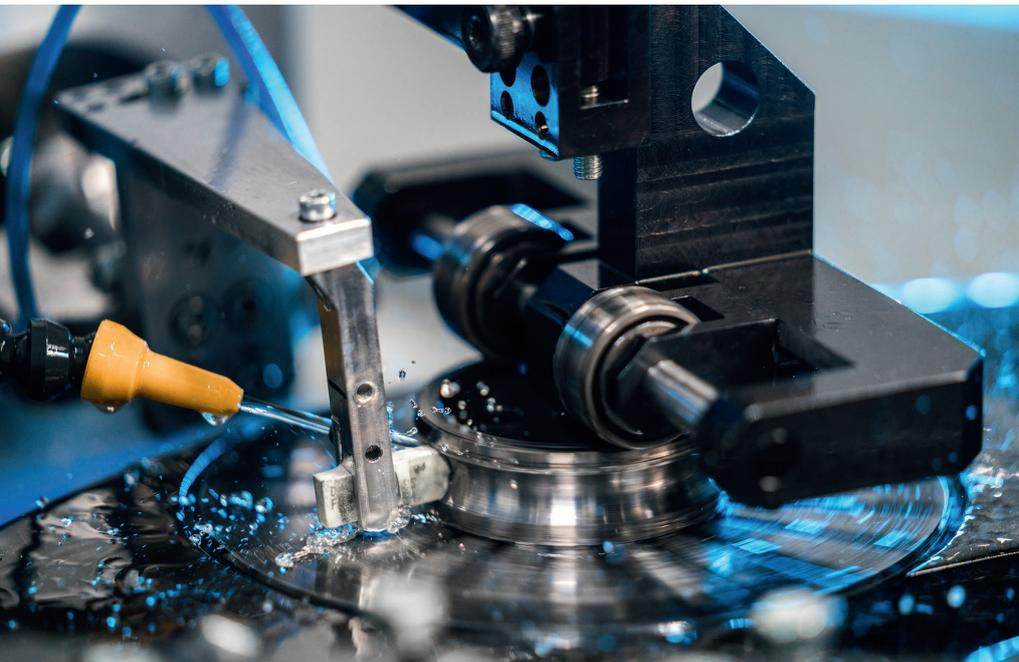
**1** Die Oszillationsmodule für Kugel- und Rollenlager lassen sich beliebig und einfach austauschen. Wahlweise werden bei der NaTrack die jeweilige radiale oder lineare Oszillation direkt verbaut © Nagel
